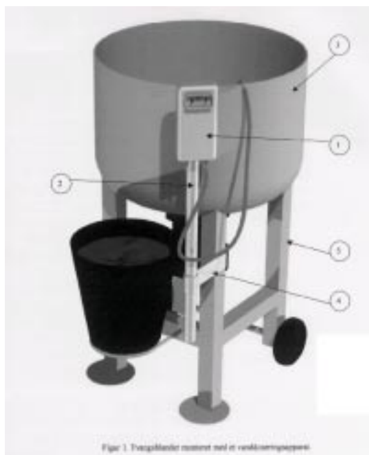
Figur 1. Tvangsblanderstativ med et vanddoseringsapparat.
