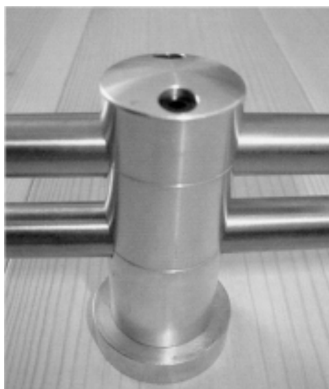
Bilag 2 (Samlet rør holder + dobbelt rørføring)
